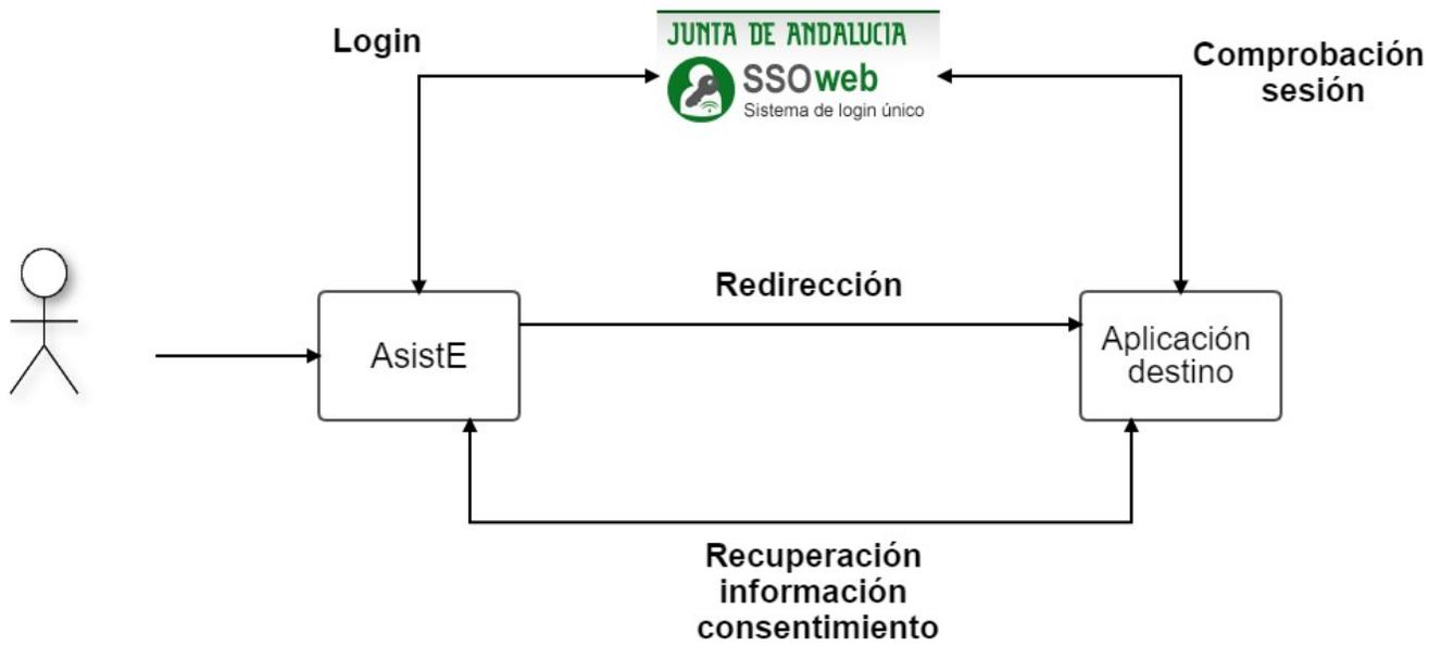
Figura 1: Ciclo funcionamiento integración AsistE con Aplicación destino
